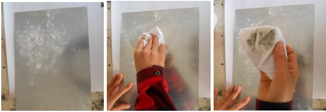
Resim 27. Çinko Levhanın Üstübeç ile Temizlenmesi.
