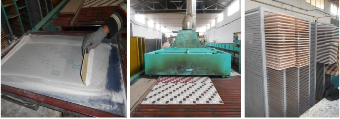
Resim 46. Cam Tozunun Elekten Seramiğe Aktarılması ve Fırınlanması.
