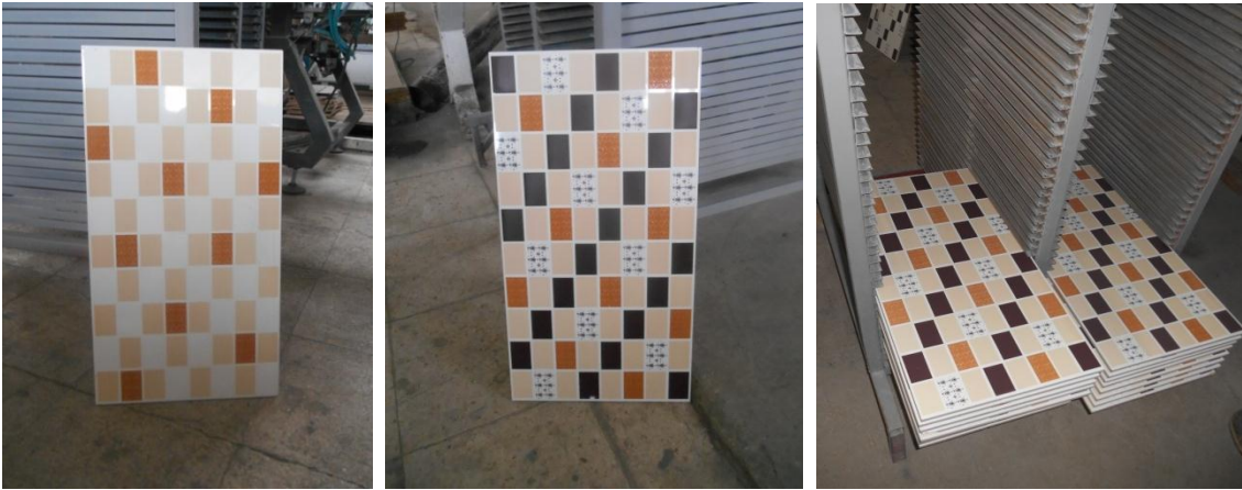
Resim 45. Baskı İşlemi Yapılmış Seramiklerin Kurumaya Bırakılması.
