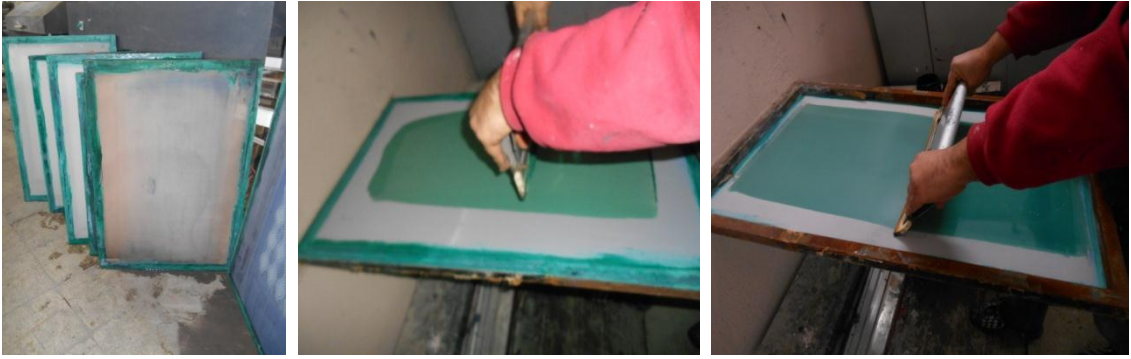
Resim 41. Kalıba Emülsiyonun Sürülmesi.
