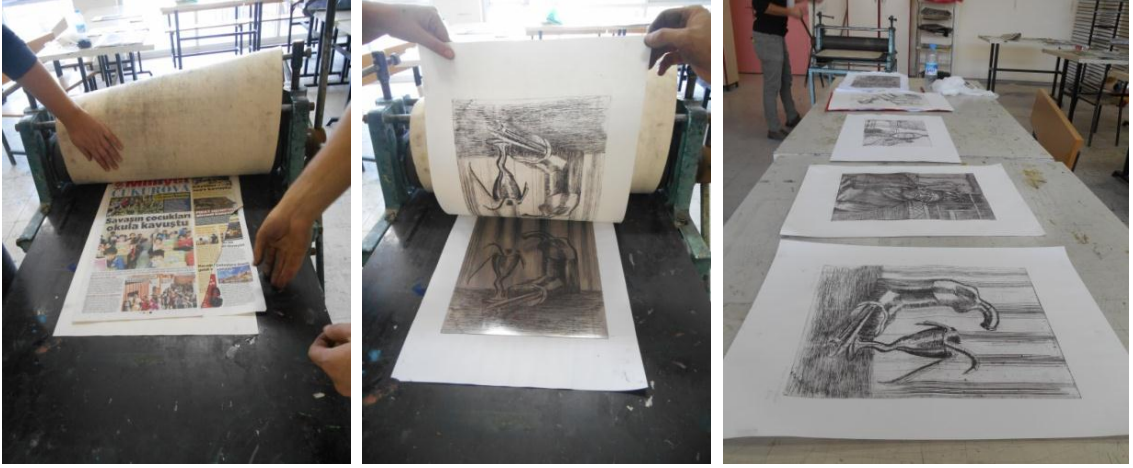
Resim 35. Baskının Alınması ve Kurumaya Bırakılması.
