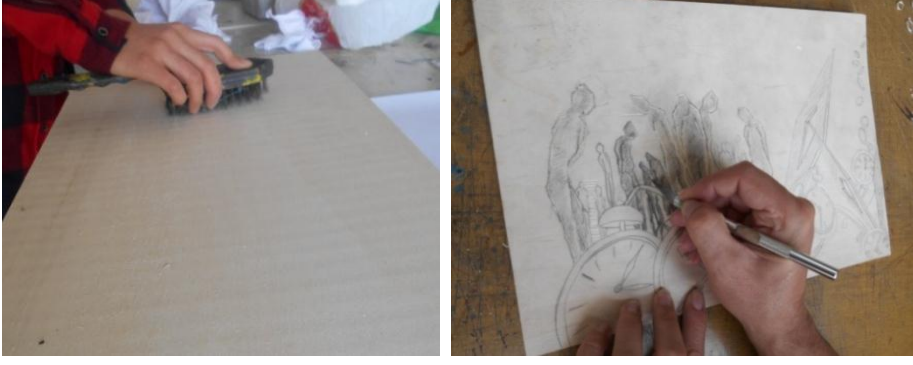
Resim 14. Ağaç Kalıbın Fırçalanması ve Tasarımda Kanal Açma İşlemi.
