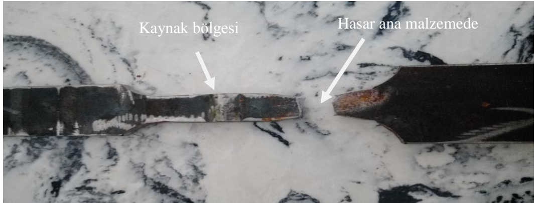
Şekil 4.21 T2-saf hasarlı numune
