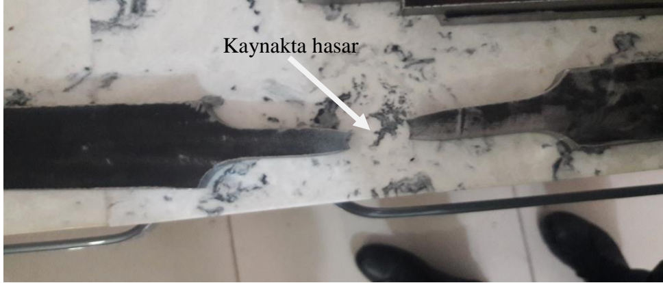
Şekil 4.19 T1 saf kaynak metalinin hasarlı numunesi
