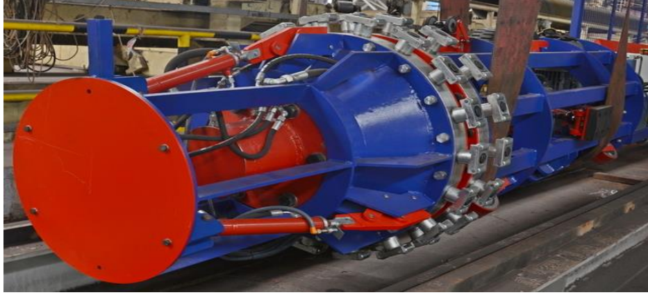
Şekil 2.6 Kaynak dikişinin merkezlenme tertibatı (Planteknik, 2019)
