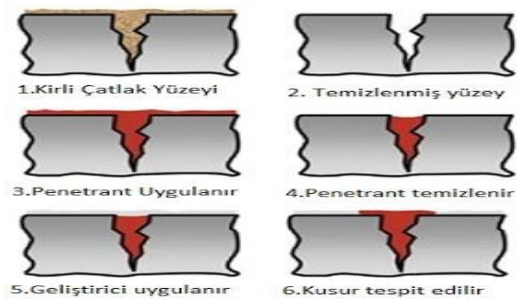
Şekil 3.13 Penetrant Uygulama Şeması (Enkon, 2018)
