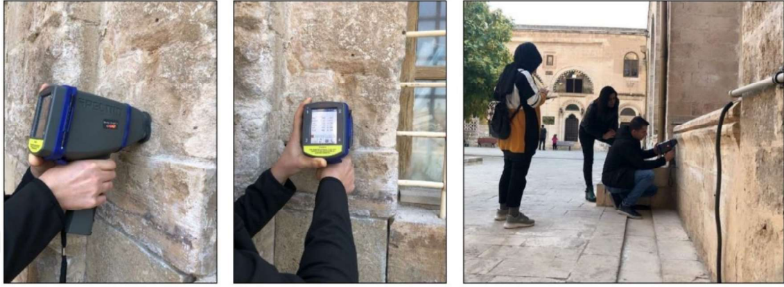
Şekil 3.17. XRF kimyasal analiz için SPECTRO xSORT / Portatif Metal Spektrometre cihazı kullanılmıştır (Kasım 2019)
