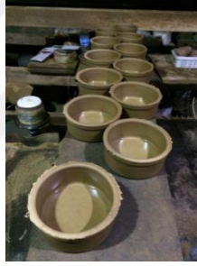
Görsel 32: Hidrolik Pres Makinesi ile Üretilen Küçük Güveçler
