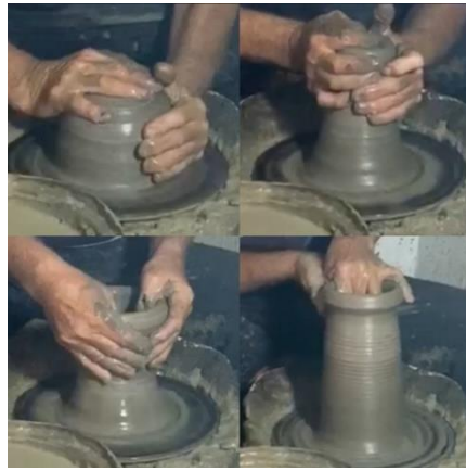
Görsel 9: Çömlekçi Tornasında Merkezkaç Kuvvetiyle Biçimlendirme
