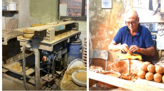
Görsel 111: Çömlekçi Tornası ve Rıfat Togay’ın Tornada Çamur Biçimlendirmesi
