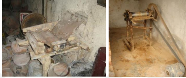
Görsel 128: İnsan Gücüyle Hareket Ettirilebilen ve Motor ile Çalışan Çamur Makinesi
