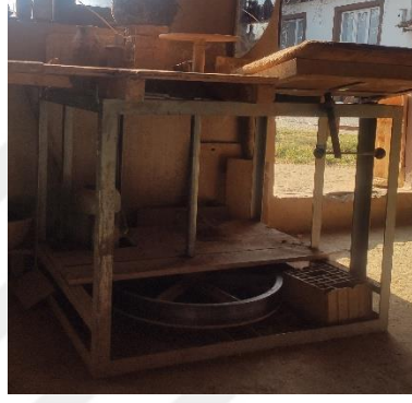
Görsel 5: Günümüzde Motor Takılarak Elektrikle Kullanılan Ayak Torna Örneği Kaynak: Yazar Arşivi
