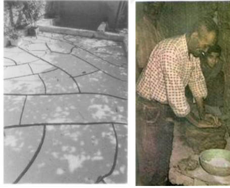
Görsel 90: Çökertme Havuzunda Çatlamış Çamur ve Çamurun Yoğrulması
