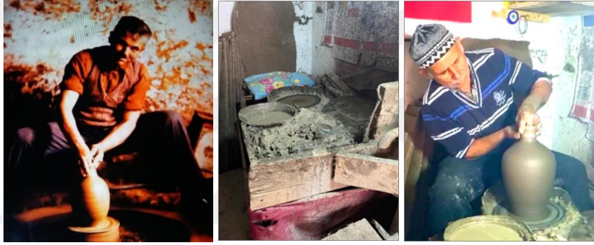
Görsel 15: Kayapa Çömlekçiliğinde Eskiden Kullanılan Torna Türü, Ahmet Tosun Usta'nın Tornası Ve Tornada Form Biçimlendirmesi
