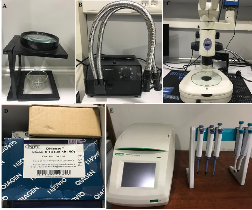
EK 2.1. Taksonomik ve moleküler analizlerde kullanılan cihaz ve malzemeler, A: mercek çapı 110 mm olan büyüteç ve kristalizuar, B: ışık kaynağı, C: stereomikroskop, D: 69500 katalog numaralı Qiagen DNeasy Kan ve Doku izolasyon kiti, E: PCR cihazı ve mikropipetler
