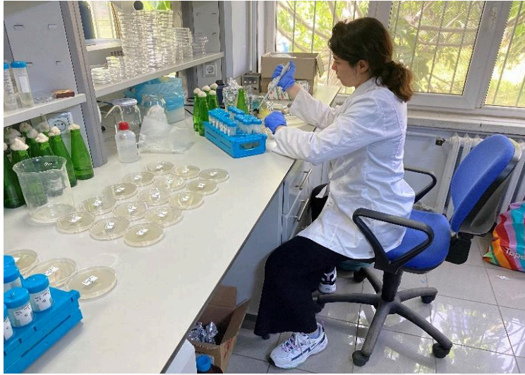
Şekil 10. AHB ve SRB’lerin izolasyonun gerçekleştirilmesi
