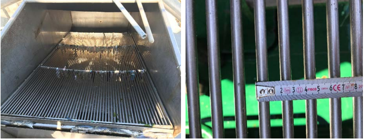
Şekil 4.14: Hamsi avcılığında kazan bölümünde bulunan 9mm aralıklı bir elek.
