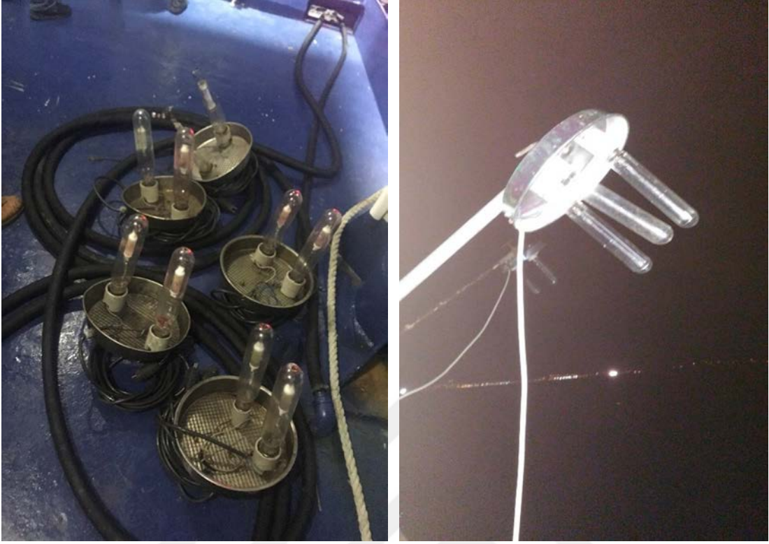
Şekil 4.11: Akkor telli lambalar ve hazırlanan tabak düzeneği.
