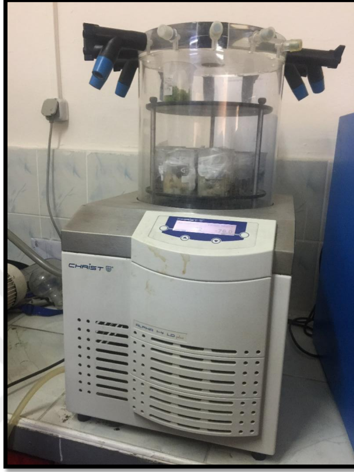
Şekil 3.3: CHRIST marka Freeze-Dryer cihazının genel görünüşü (Orijinal).
