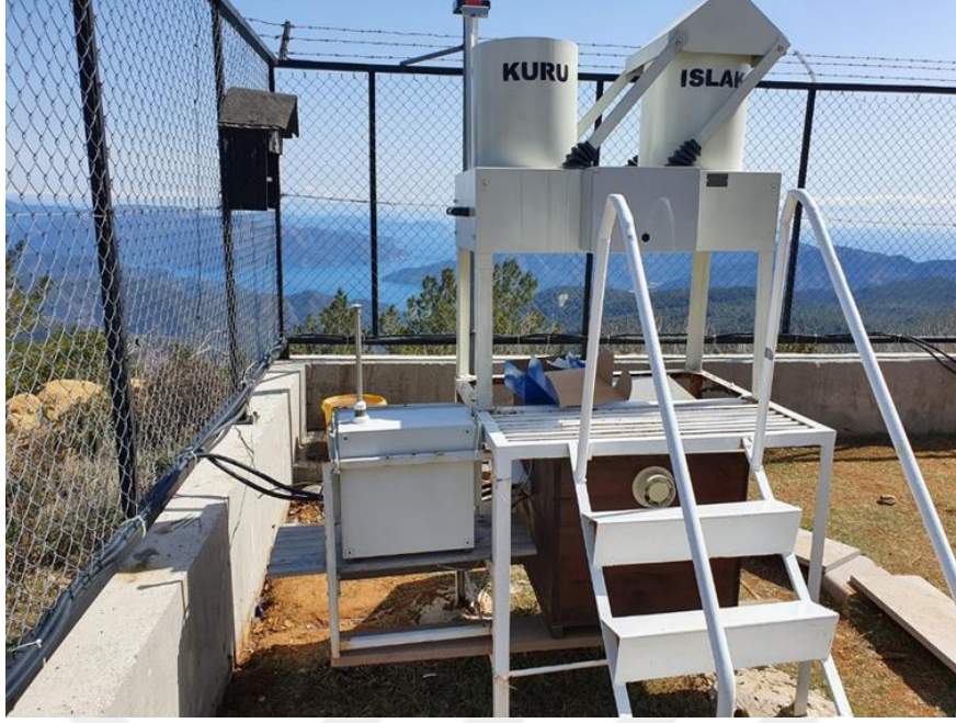
Fotoğraf 3.3. Marmaris İstasyonu'nda kullanılan otomatik yağmur örnekleyici
