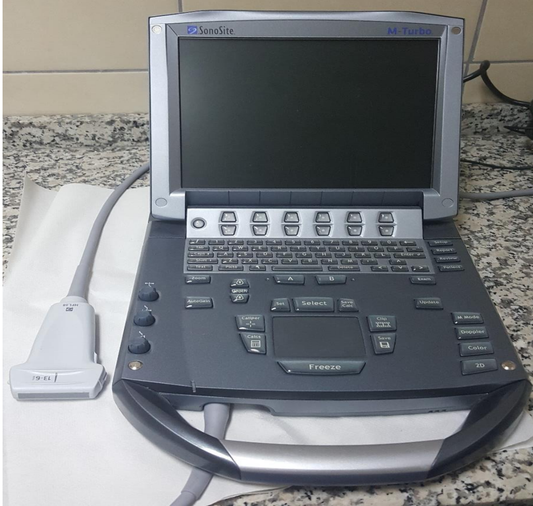
Resim 3.3. Fujifilm SonoSite M-Turbo (Fujifilm, USA) ultrasonografi cihazı ve tarama derinliği 6 cm olan HFL38X 13-6 MHz lineer prob
