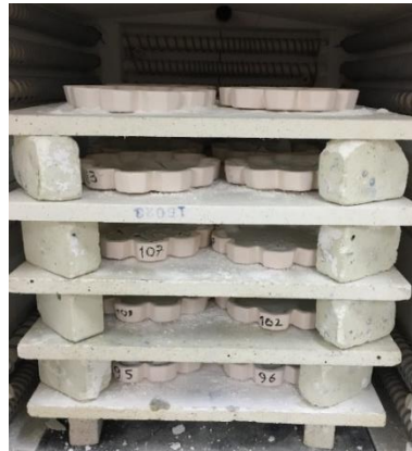
Görsel 3.8. Sırlı Deneme Plakalarının Fırına Yerleştirilmesi (Öztürk Razi,2018)
