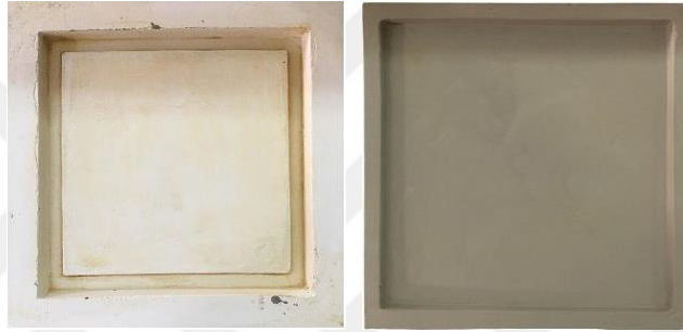
Görsel 4.1. Kare Formun Kalıbı ve Kalıptan Çıkarılan Ürün (Öztürk Razi,2018)
