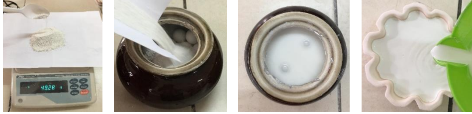
Görsel 3.6. Sırın Tartılması, Öğütülmesi ve Uygulama Aşamaları (Öztürk Razi,2018)
