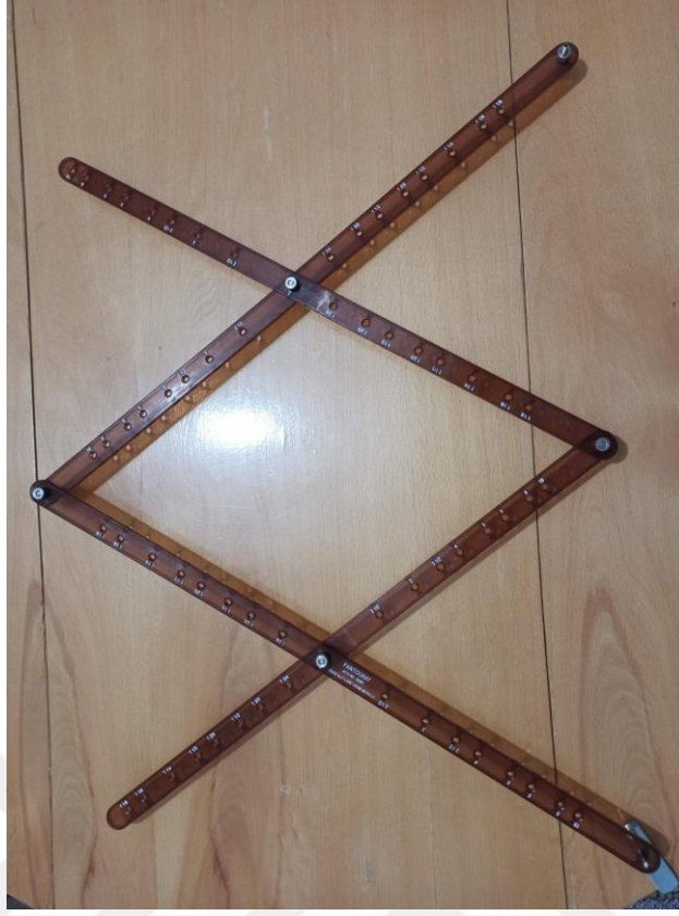
Şekil 3. Pantograf aleti açık hali
