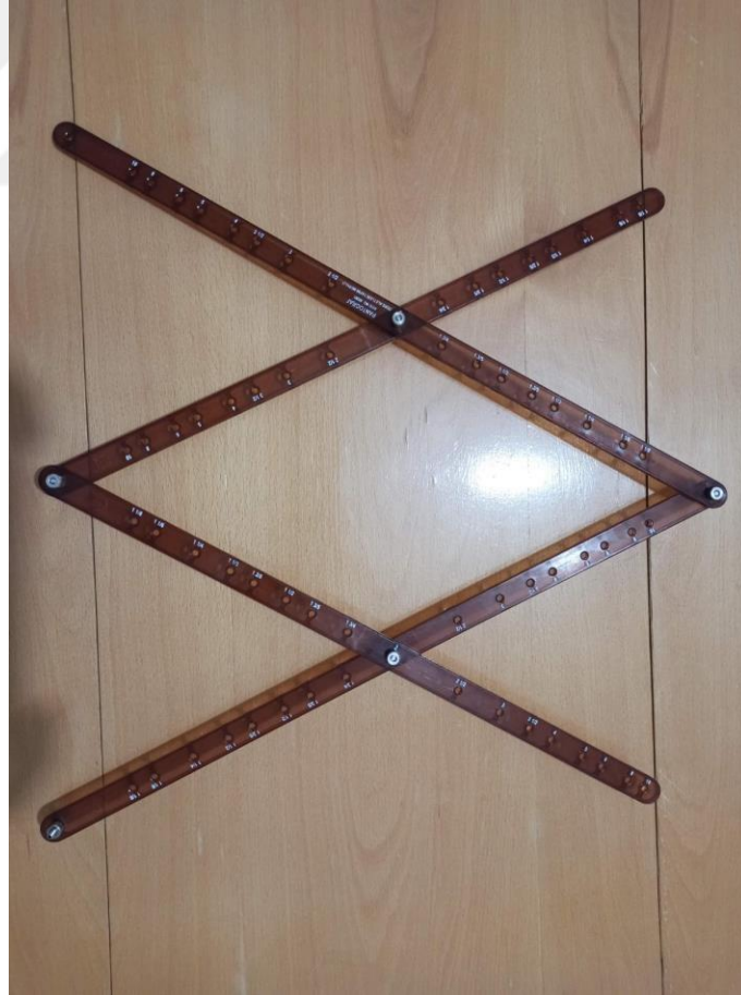
Şekil 2. Pantograf aleti açık hali
