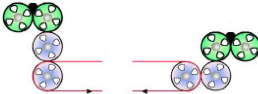
Şekil 2.16 Kalandır ile kaplama yöntemi [48]
