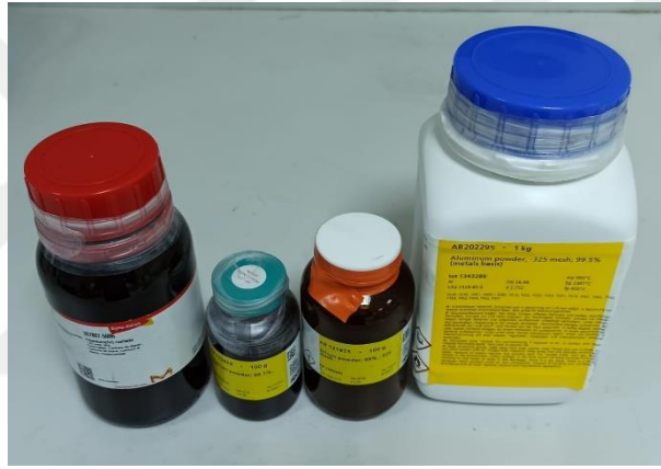
Şekil 3.1 Ti_3SiC_2 MAX fazı bileşiğinin sentezlenmesinde kullanılan hammaddeler
