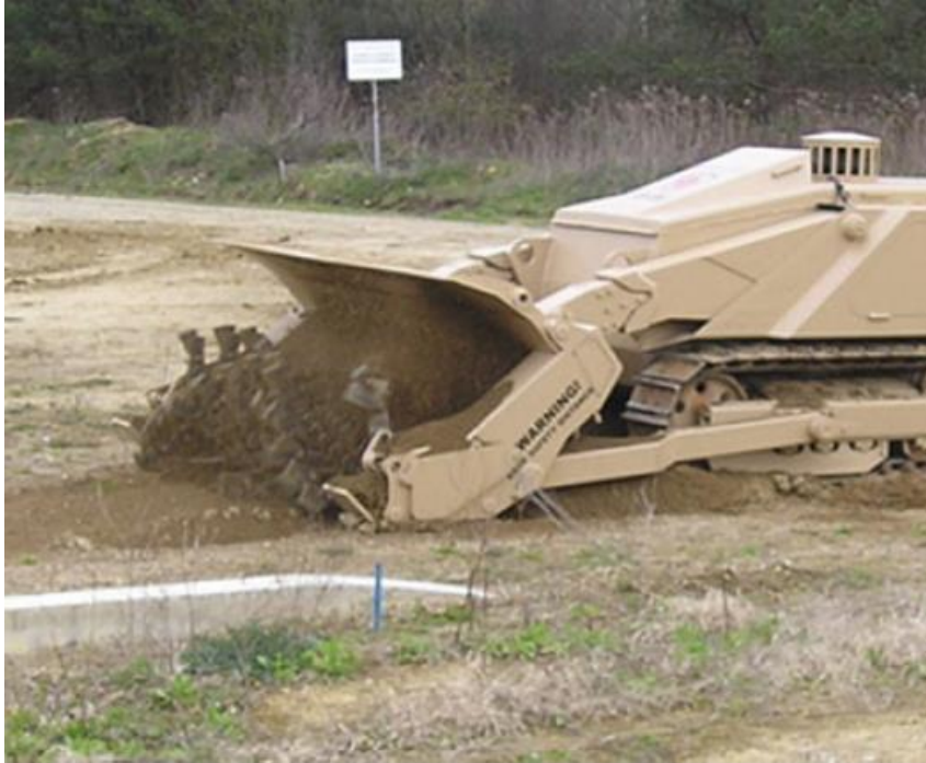
Resim 2.9 Tiller ile mayın temizleme makinasının testleri (Mikulic 2012).
