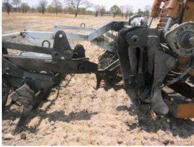
Resim 2.3 Kltivatr ile mayın temizleme operasyonu (İnt.Kyn.4).
