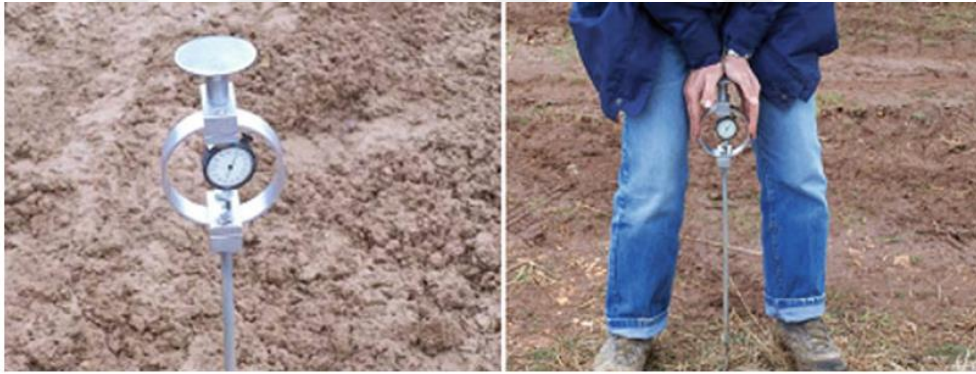
Resim 2.7 Penetrometre ile toprak koni indeksi ölçümü (Mikulic 2012).
