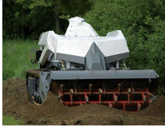
Resim 2.6 Tiller ataşmanı ile mayın temizleme operasyonu (İnt.Kyn.7).
