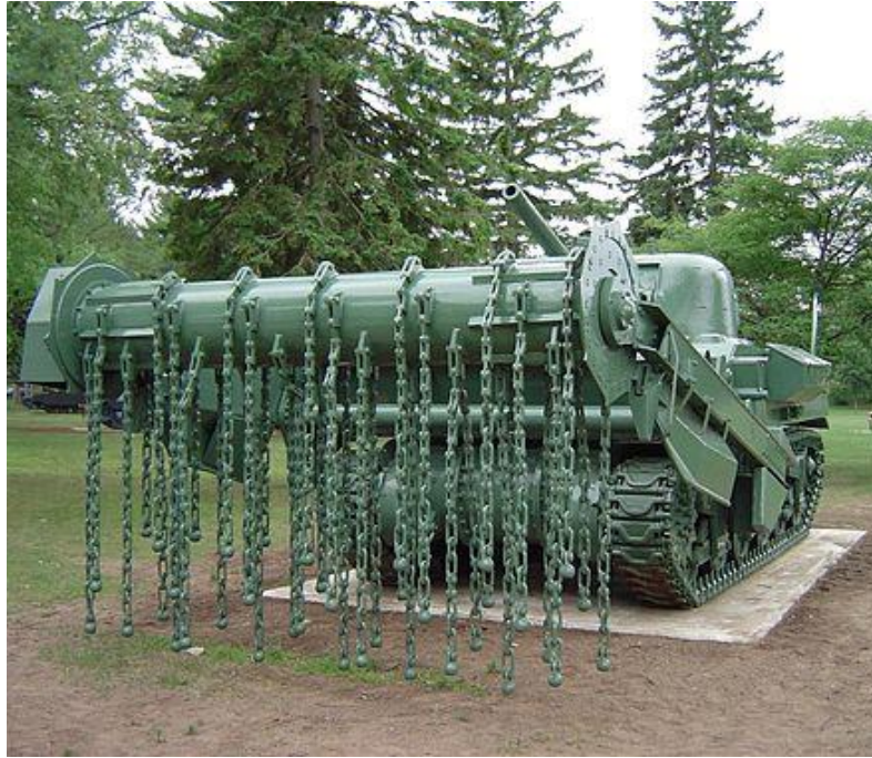
Resim 2.5 Zincire bağlı tokmaklar ile döverek mayın temizleme operasyonu (İnt.Kyn.6).
