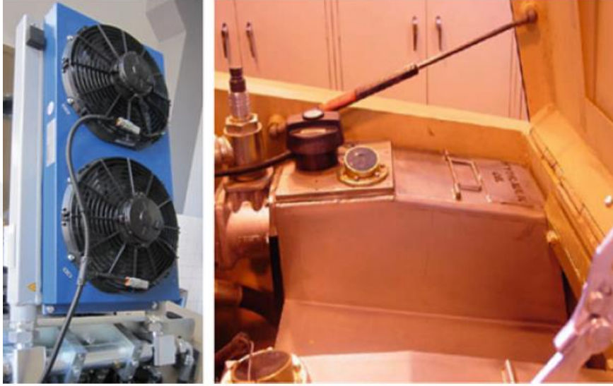
Resim 2.11 Hidrolik yağ ısı değiştiricisi ve hidrolik tank (Mikulic 2012).
