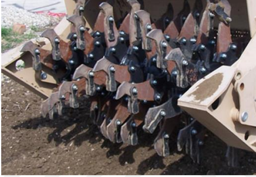
Resim 2.8 Tiller çalışma takımı şekli, "kulaklı" kama bıçağı (MV-4) (Mikulic 2012).
