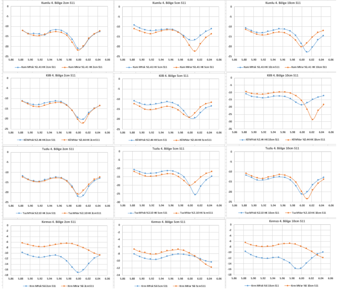
Şekil 3.15. 4. Rezonans bölgesi, kumlu, killi, tuzlu ve kırmızı toprağın 2, 5 ve 10 cm için S_{11} grafikleri
