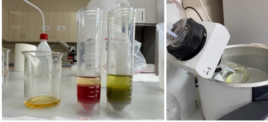
Şekil 16. Ekstraksiyon ve çözücü uçurma
