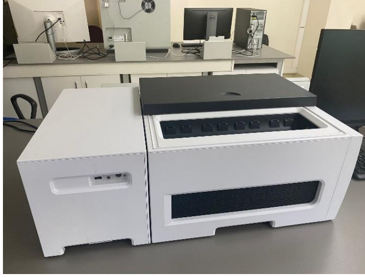
Şekil 10. UV/VIS spektrofotometre cihazı
