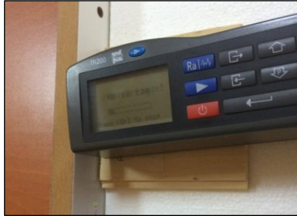
Şekil 4.7. Delik İçi Pürüzlülüğün Ölçülmesi
