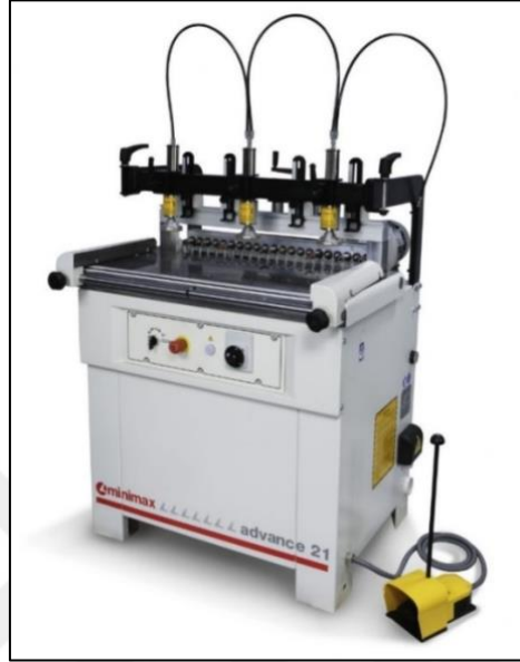
Şekil 3.4.Çoklu delik delme makinesi ( https://mktmakina.com.tr , 2020)
