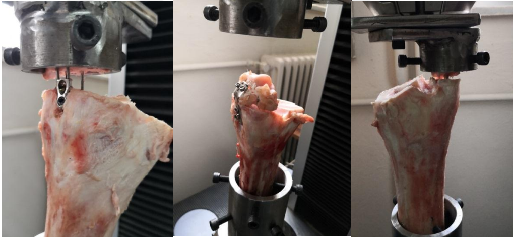
Şekil 35. Çekme kuvvetlerinde katastrofik hasar anları
