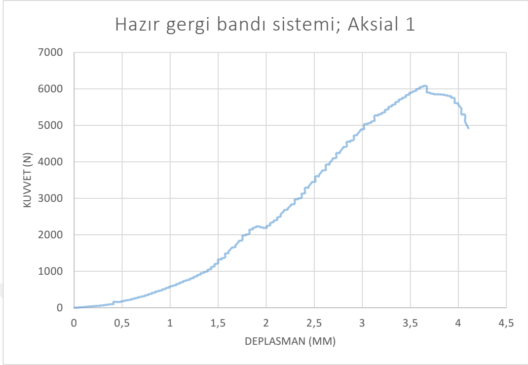
Şekil 4. 11. Hazır gergi bandı sistemi yöntemi uygulanan kemiğe aksial kuvvet uygulamasının sonuçları
