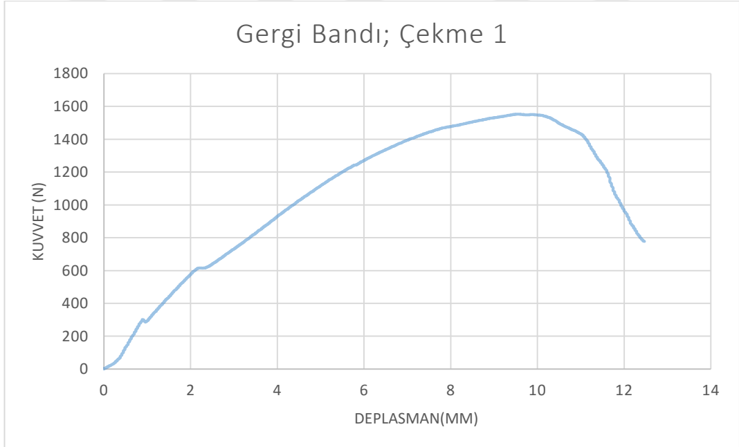
Şekil 4. 17. Gergi bandı yöntemi uygulanan kemiğe çekme kuvveti uygulamasının sonuçları
