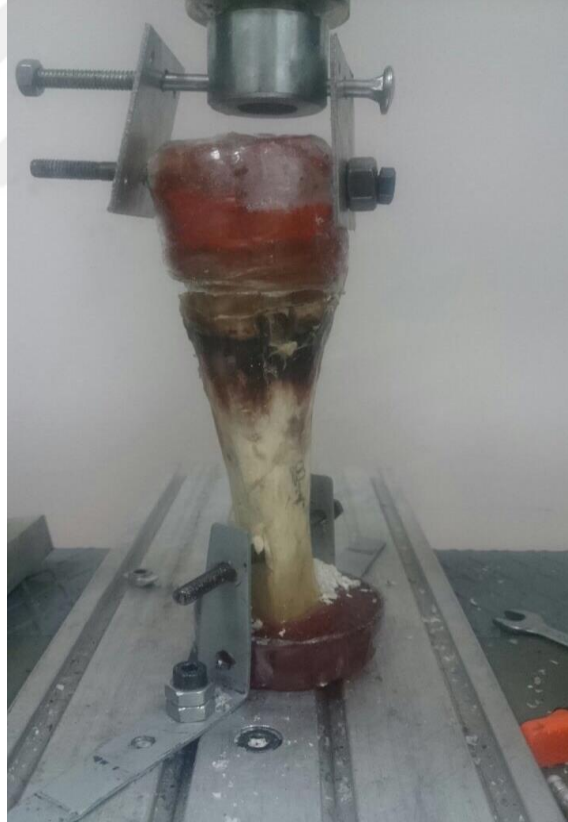
Şekil 3. 3. Bikortikal vida yöntemine çekme kuvveti uygulanması
