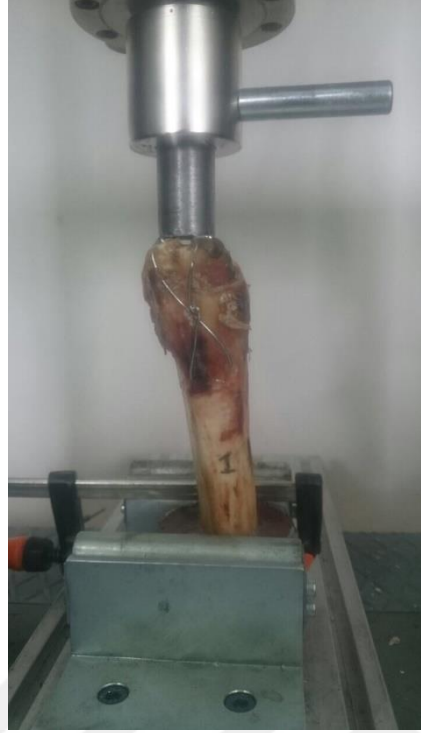
Şekil 3.8. Gergi bandı yöntemi uygulanan kemiğe aksiyel kuvvet uygulanması
