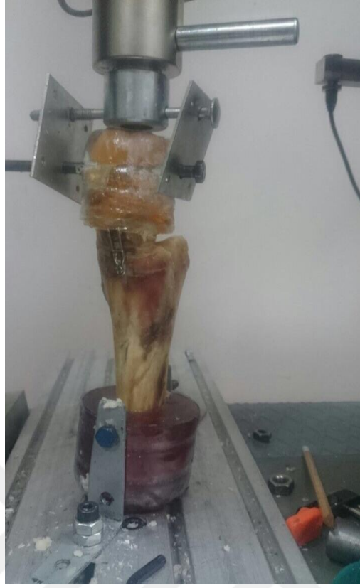
Şekil 3. 4. Hazır gergi bandı sistemi yöntemine çekme kuvveti uygulanması
