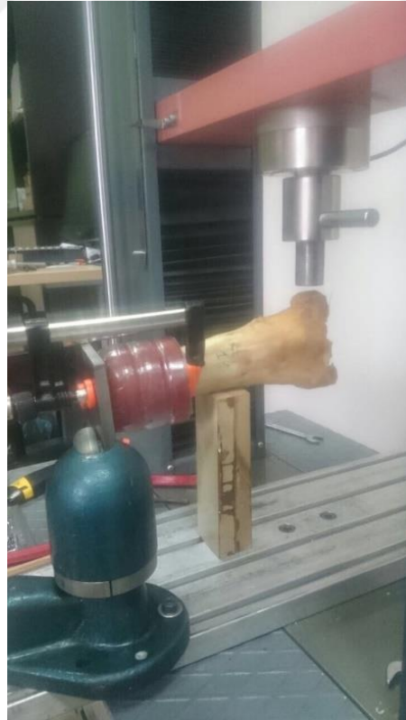
Şekil 3. 5. Bikortikal vida yöntemine transvers kuvvet uygulanması
