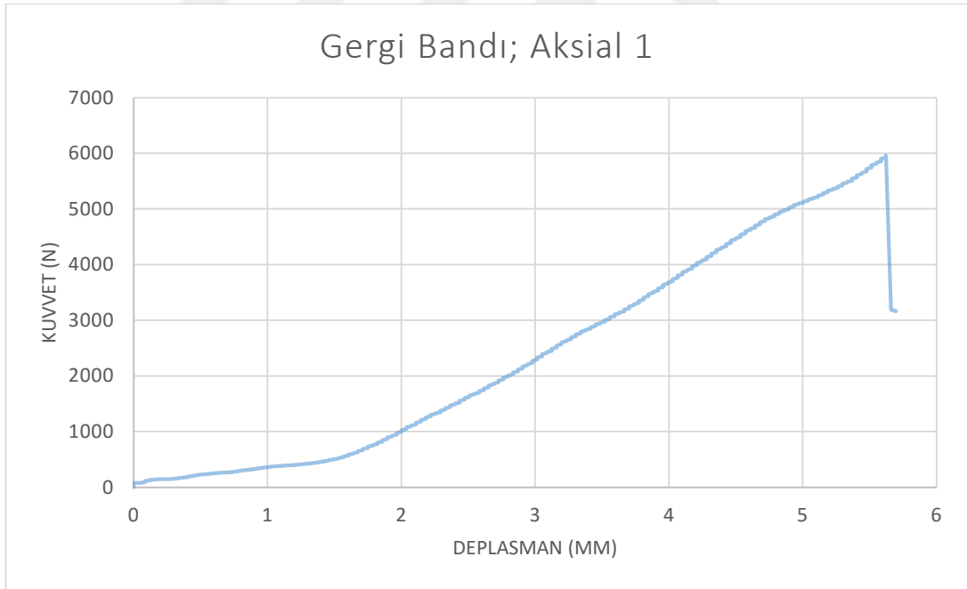
Şekil 4. 10. Gergi bandı yöntemi uygulanan kemiğe aksial kuvvet uygulamasının sonuçları
