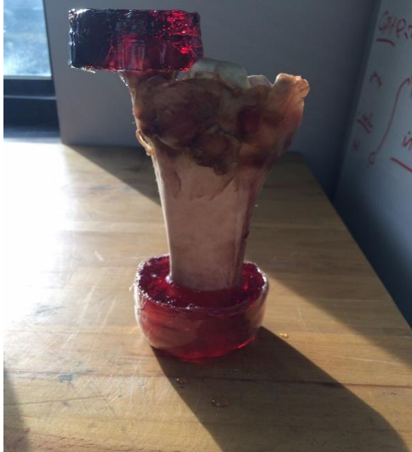
Şekil 3. 1. Bikortikal vida yöntemi uygulanan kemiklere polietilen kalıp uygulanması
