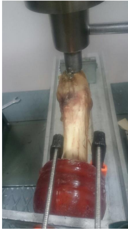
Şekil 3.7. Hazır gergi bandı sistemi yöntemine transvers kuvvet uygulanması
