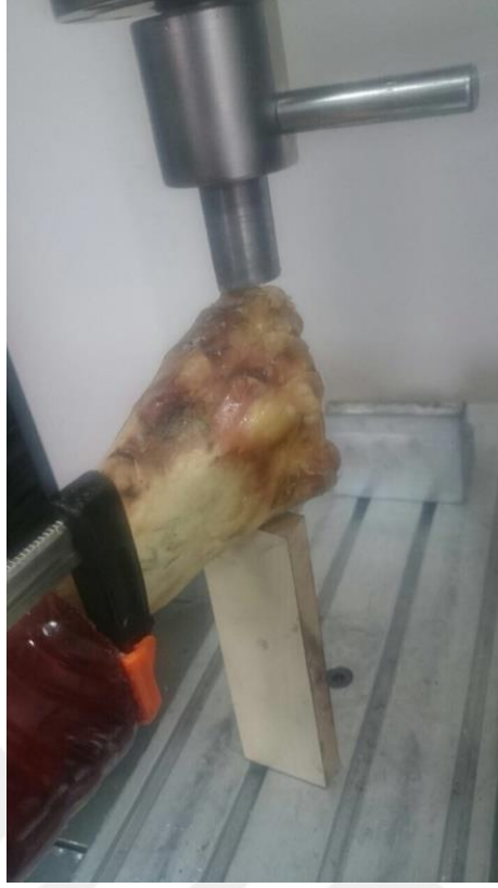
Şekil 3. 6. Malleol vidası yöntemine transvers kuvvet uygulanması
