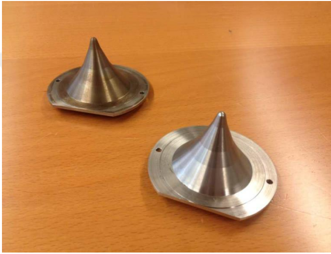
Şekil 2.17. Tipik bir medikal linak'ta bulunan düzleştirici filtre (Weber vd. 2017)
