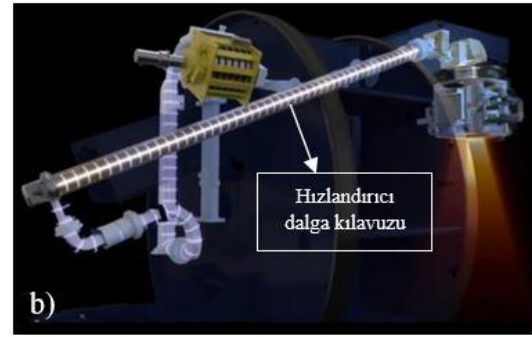
Şekil 2.13. a) Hızlandırıcı dalga kılavuzunun kesitsel görünümü; b) Hızlandırıcı dalga kılavuzunun bir medikal linak'taki konumu
