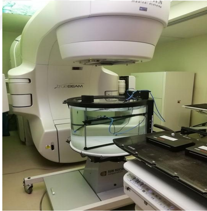
Şekil 3.11: Lineer Hızlandırıcıda kalite kontrol ölçümleri için su fantomu ölçüm düzeneği.
