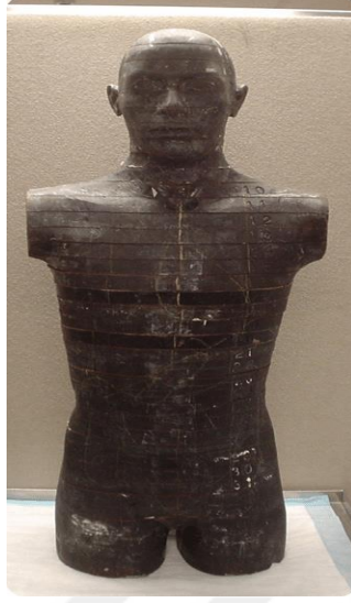
Şekil 3.10: 10 MV Reel ve 10 MV Sanal enerjiler kullanılarak Tedavi Planlama Sisteminde plan karşılaştırması yapmak amacıyla kullanılan rando fantom.
