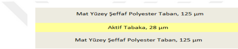
Şekil 3.6: Gafchromic EBT3 Dozimetri Filminin Konfigürasyonu.
