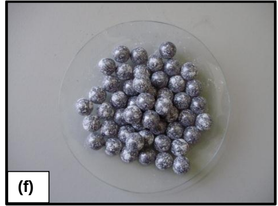
Şekil 4.2. Belirlenen koşullarda 5 (a,b), 10 (c,d) ve 15 (e,f) dakika öğütme sonunda havan ve bilyaların durumu
