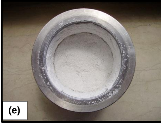
Şekil 4.2. Belirlenen koşullarda 5 (a,b), 10 (c,d) ve 15 (e,f) dakika öğütme sonunda havan ve bilyaların durumu
