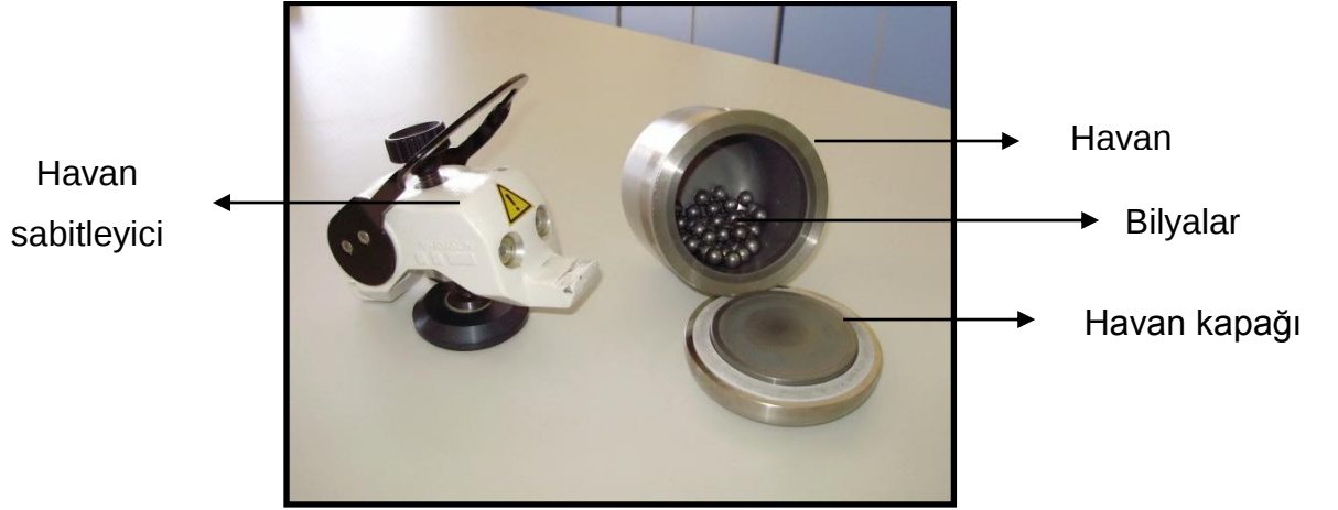
Şekil 3.5. Mekanik aktivasyon işlemlerinde kullanılan havan ve bilyalar
