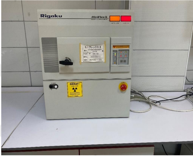
Şekil 3.6. Tezimizde kullanılan XRD cihazı
