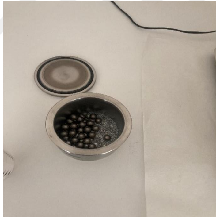
Şekil 3.3. Kullanılan Bilyalar ve Havan
