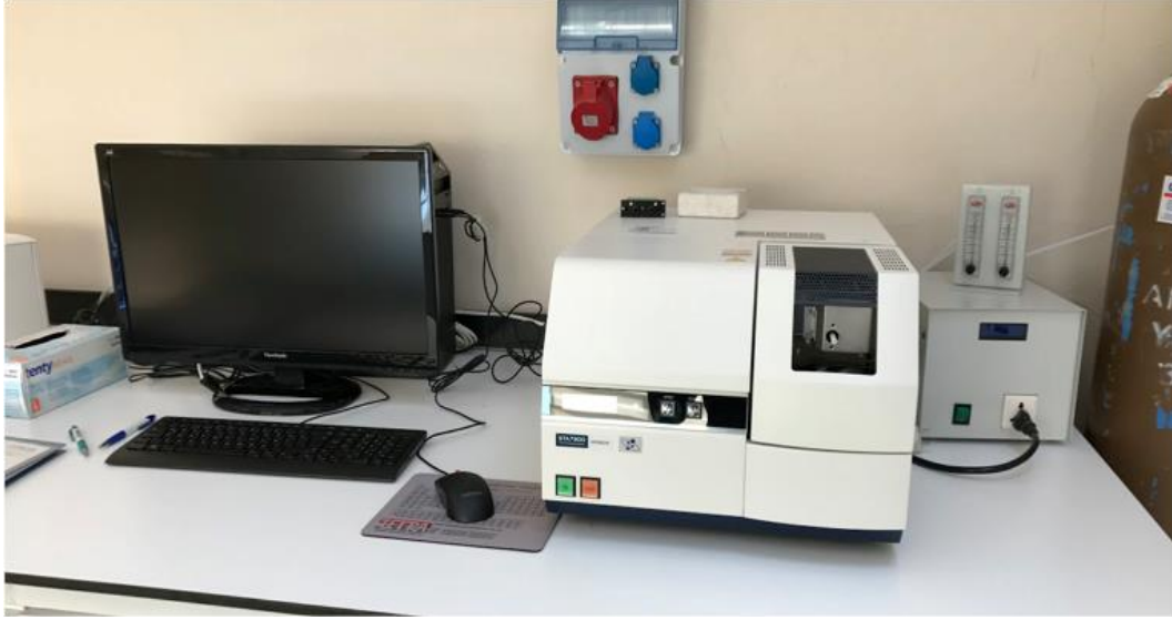
Şekil 3.11. Tezde kullanılan DTA cihazı
