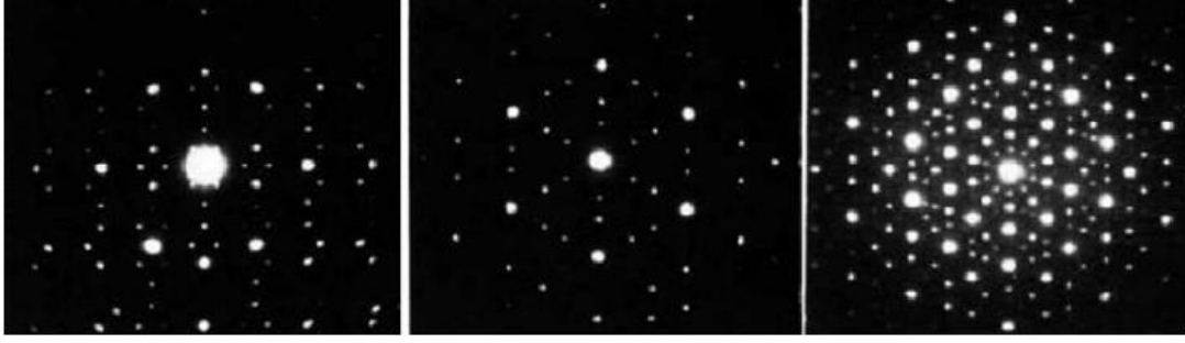
Şekil1.10. \text{Al}_{86}\text{Mn}_{14} alaşımının kırınım modeli (Soldan sağa doğru) 2katlı 3katlı 5katlı simetri eksenleri boyunca yönelmiştir. (Shechtman ve ark., 1984)
