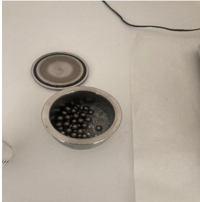
Şekil 3.3. Kullanılan Bilyalar ve Havan
