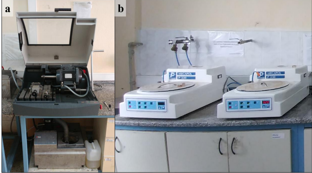
Şekil 3.1 Disk kesme (a), zımparalama ve parlatma (b) cihazları (Kişisel arşiv, 2022)
