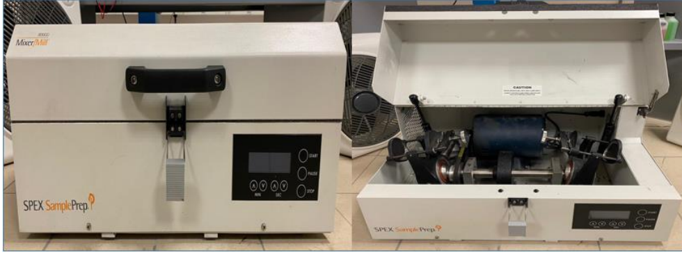
Resim 4.2 Mekanik Alaşımlama işlemi için kullanılan SPEX™ Değirmen.
