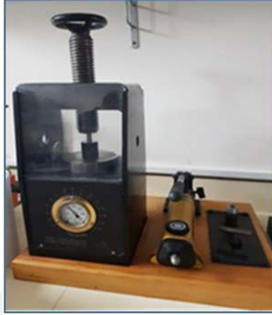
Resim 4.5 Tozların preslenmesinde kullanılan tek eksenli Hidrolik Pres.
