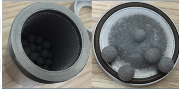
Resim 4.3 Mekanik Alaşımlamada kullanılan kaplardaki (vial) soğuk yapışma.
