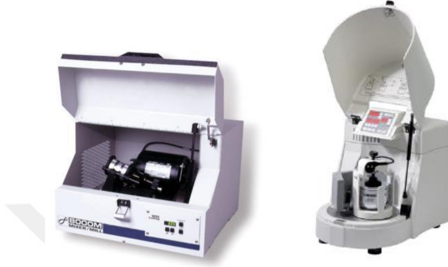
Şekil 3.5 a) Mekanik alaşımlama için kullanılan öğütücü SPEX™ b) Gezegen tipi öğütücü FRITCH™.
