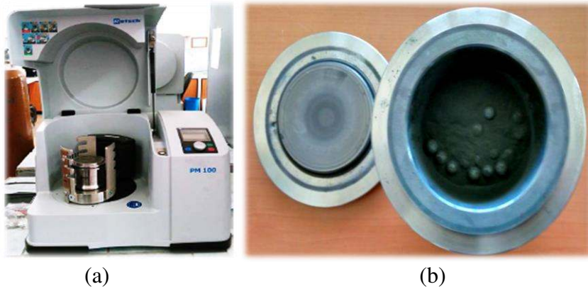
Şekil 2.5. MA işleminde kullanılan ekipmanlar; (a) bilyalı öğütücü, (b) hazne ve bilyeler
