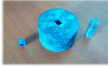
Şekil 2.9. Aşınma numunesi üretiminde kullanılan kalıp
