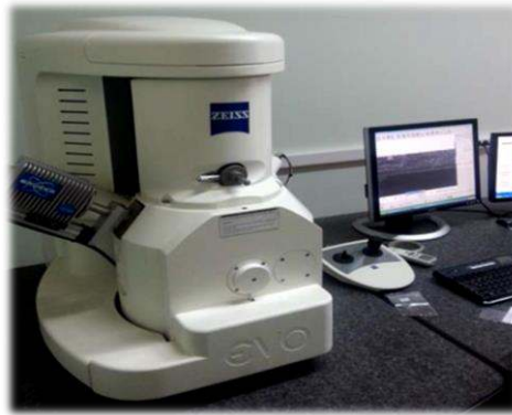
Şekil 2.7. Toz morfolojisi, içyapı ve aşınma yüzeylerinin incelenmesinde kullanılan taramalı elektron mikroskobu (SEM)
