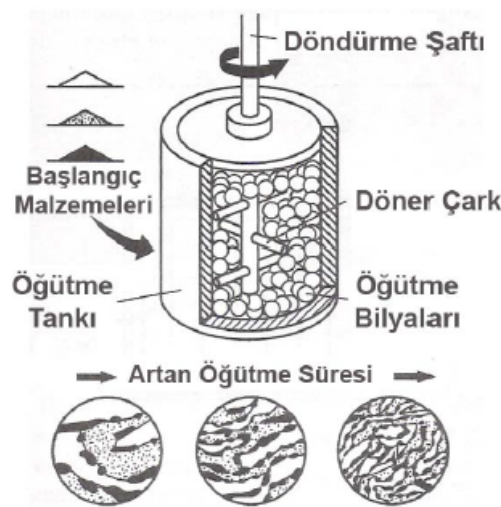
Şekil 3.4 : MA sürecinde mikroyapı değişimi [95].
