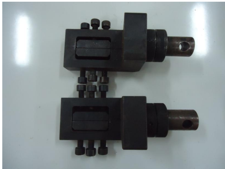
Şekil 4.13 Kayma testleri sırasında kullanılan aparat
