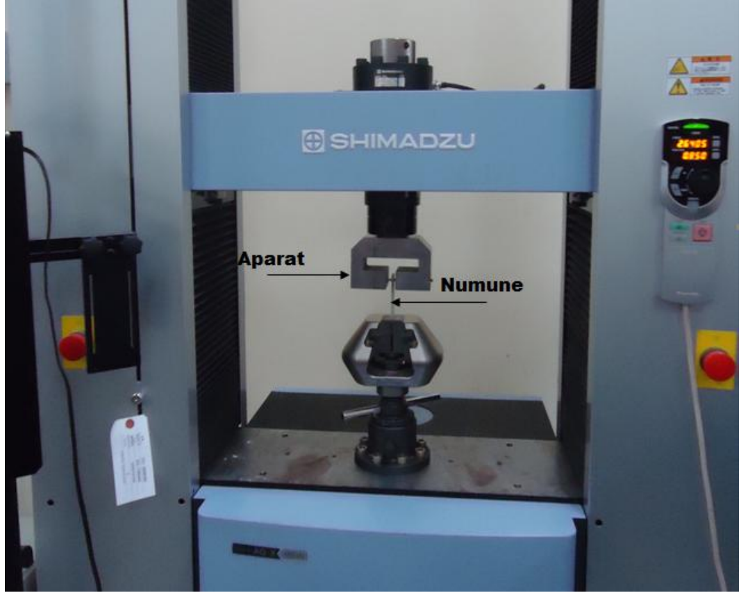
Şekil 4.16 Pim bağlantılı çekme deneyi
