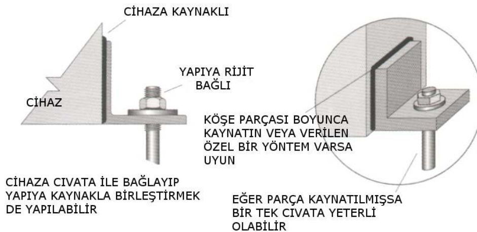
Şekil 3.6. Köşe takviye parçasının ekipmana kaynatılması*
