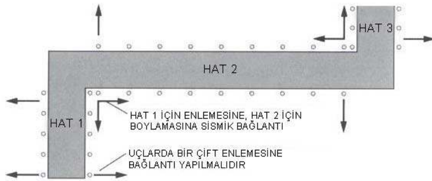
Şekil 3.27. Hat dönüşü köşelerinde enlemesine ve boylamasına sismik bağlantı yerleşimi*
