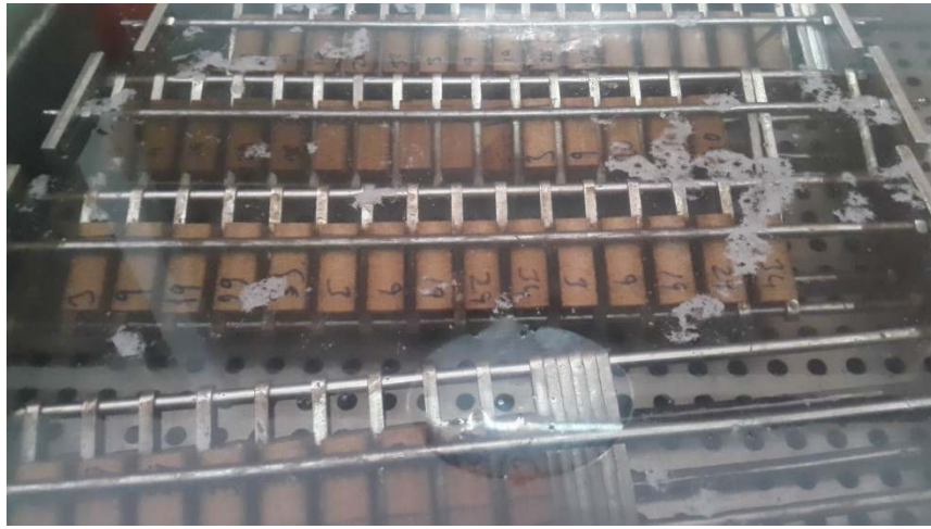
Şekil 2.3. Su alma ve kalınlık artımı testi için parçaların suda bekletilmesi.
