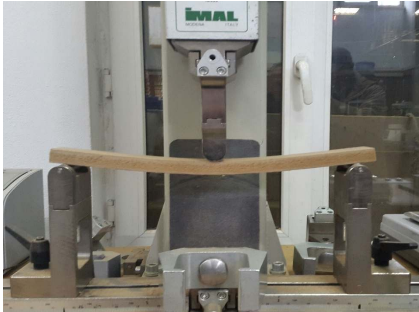
Şekil 2.4. Eğilme direnci testinin yapılışı.
