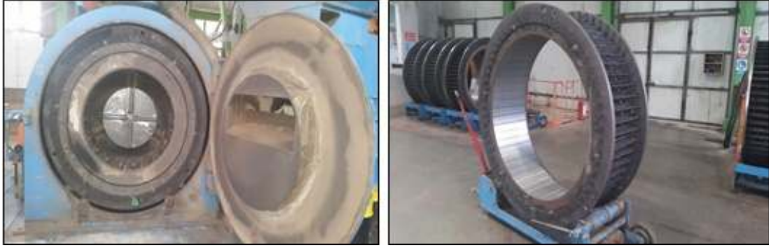
Şekil 1.9. İnceltme değirmeni ve kesici bıçak rotoru.
