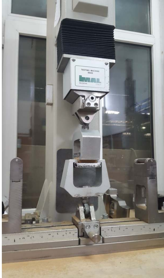
Şekil 2.5. Yüzeye dik çekme testinin yapılışı.
