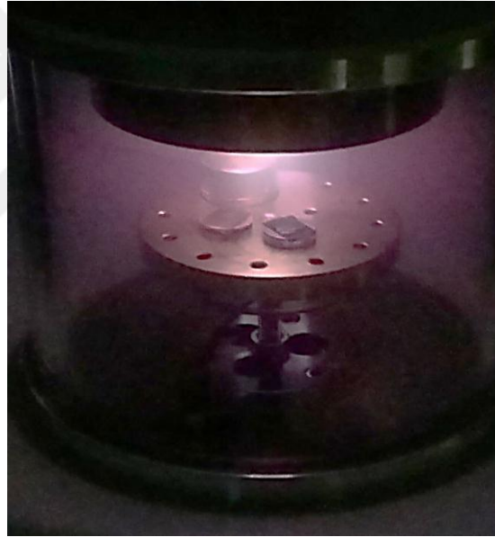
Şekil 2.3 : Altın püskürtme sırasında numuneler.
