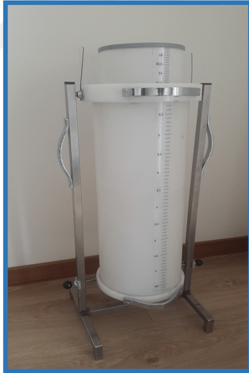
Resim-2: Kolay ölçüm volümetresi (devirme sehpalı)
