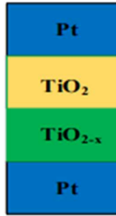
Şekil 2.13. HP tarafından önerilen memristör modeli (Keshmiri, 2014).
