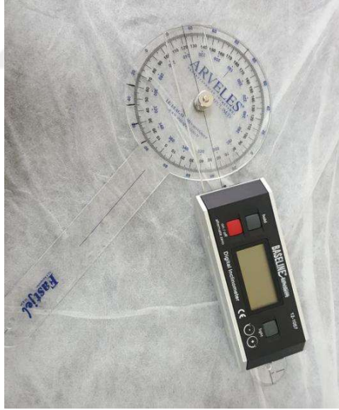
Şekil 3.1. Gonyometre üzerine adapte edilmiş dijital inklinometre cihazı
