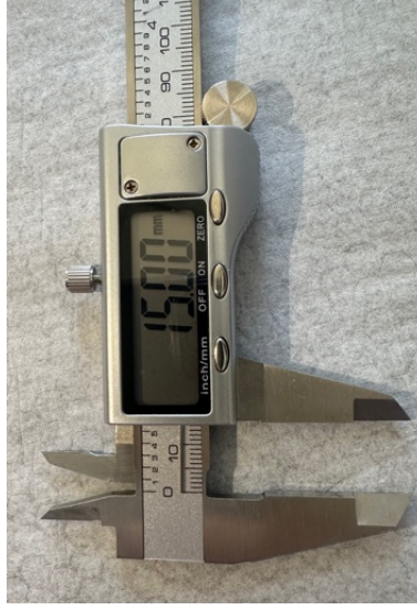
Şekil 3.7: Kumpas ile ölçülen 15 mm'lik ortodontik Tel
