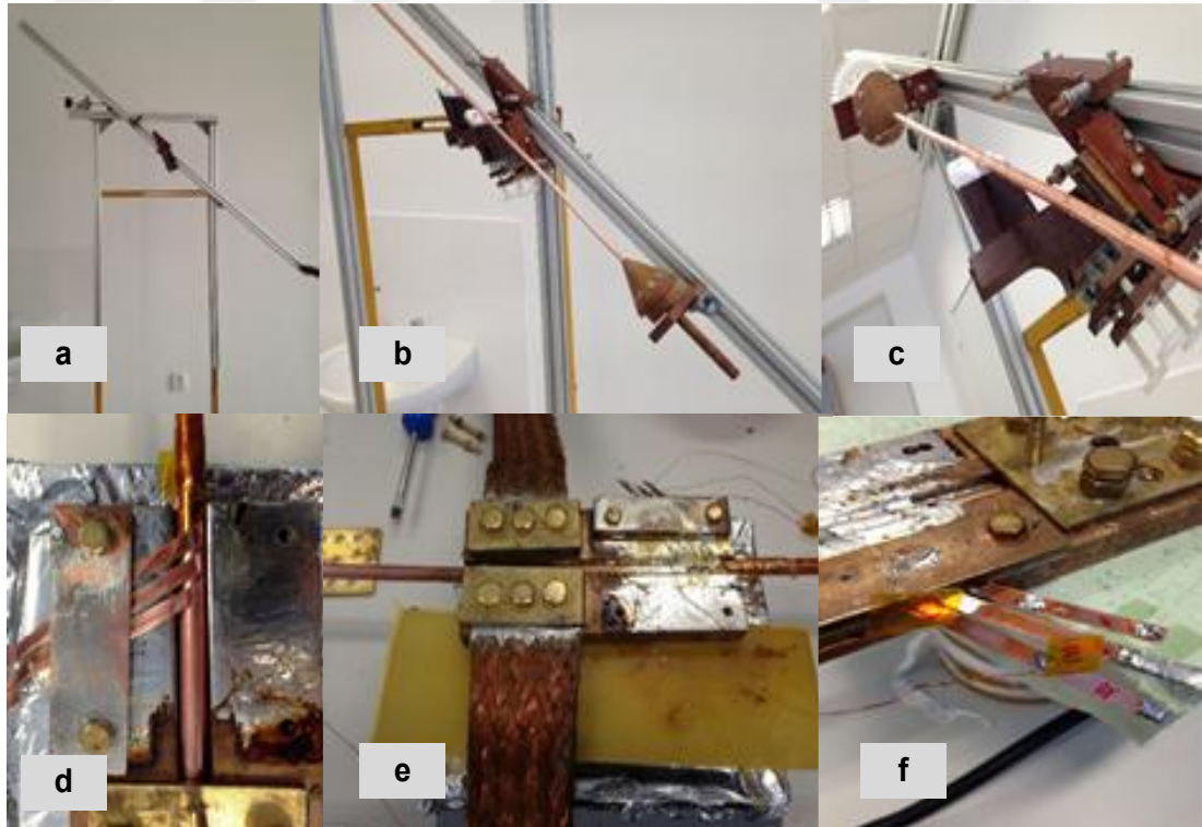
Şekil 5.14. CORC kablo yapım adımları
