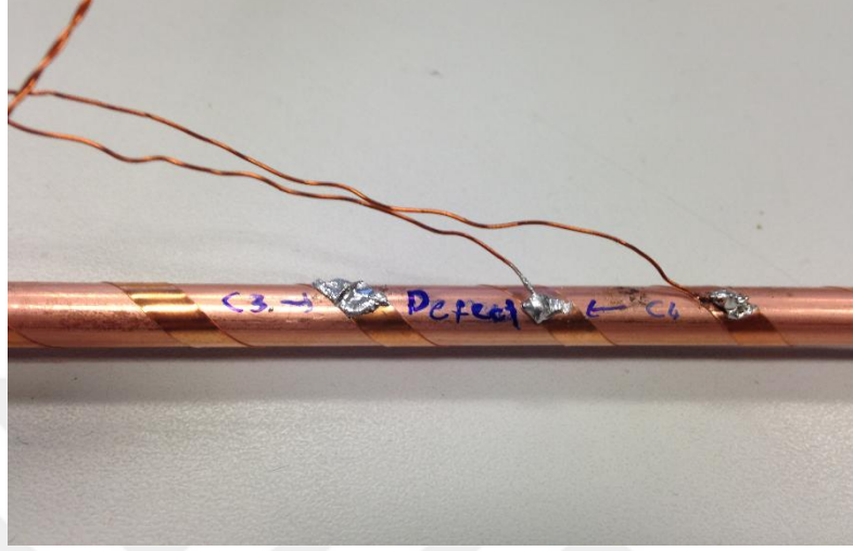
Şekil Ek-2.5. Kablonun zarar görmüş bölgesi.
