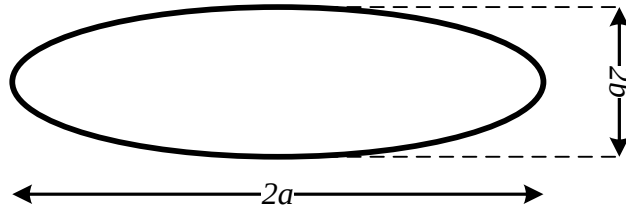
Şekil 2.26. Elips iletkenin kesit alanı ve boyutları
