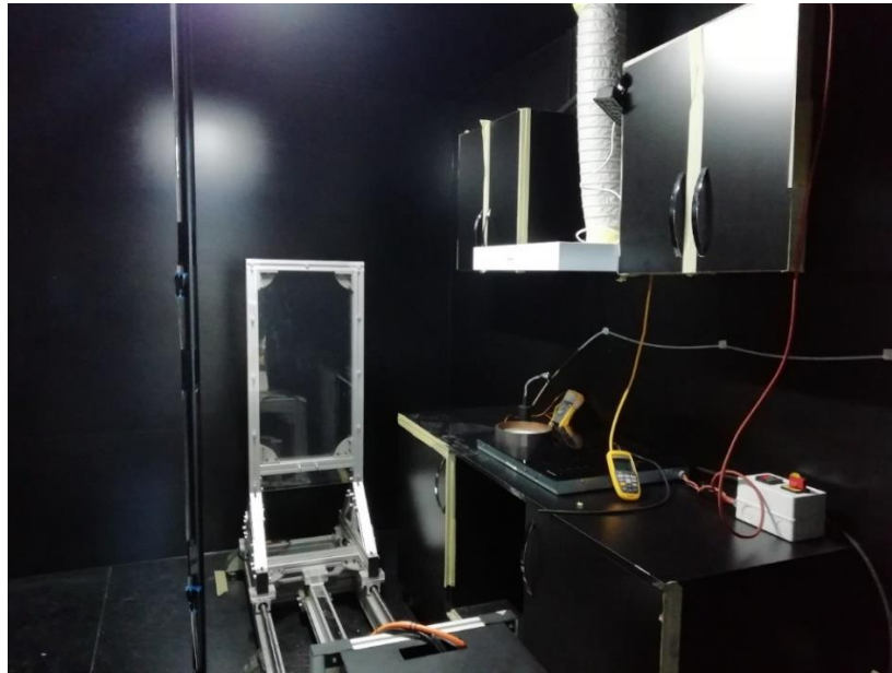
Şekil 4.18. Koku çekme performans deney düzeneği
