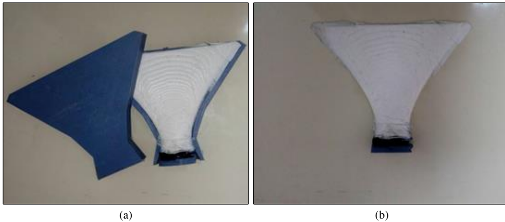
Şekil 5.15. Esnek kuyruk yüzgecinin üretimi: (a) Dış kalıplar, (b) Esnek kuyruk yüzgeci
