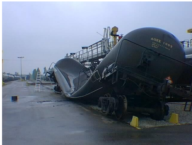
Şekil 2.4. Uygulamada stabilite kaybından kaynaklanan burkulma örneği
