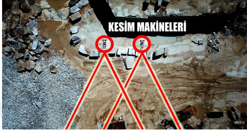
Şekil 4.10 Mermer ocaklarında bulunan tel kesme makinelerinin üstten görünüşü.
