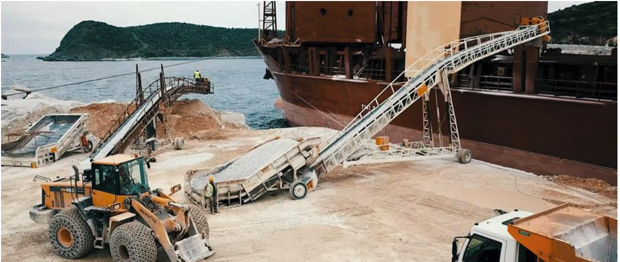
Şekil 3.14 Gemi yüklemelerinde kullanılan mobil bunker ve konveyör kombinasyonu.
