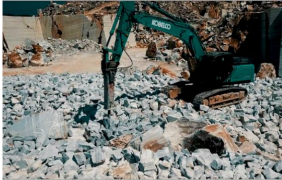
Şekil 3.5 Mermer blok artıklarının ön kırılması ve nakliyatı.
