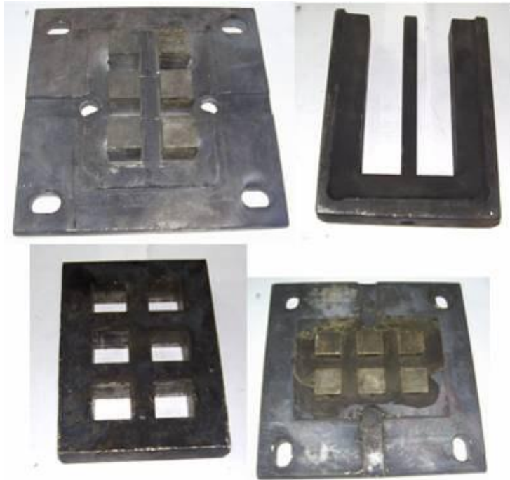
Resim 3.17 Deney Numunelerinin Üretildiği Sıcak Presleme Kalıbı
