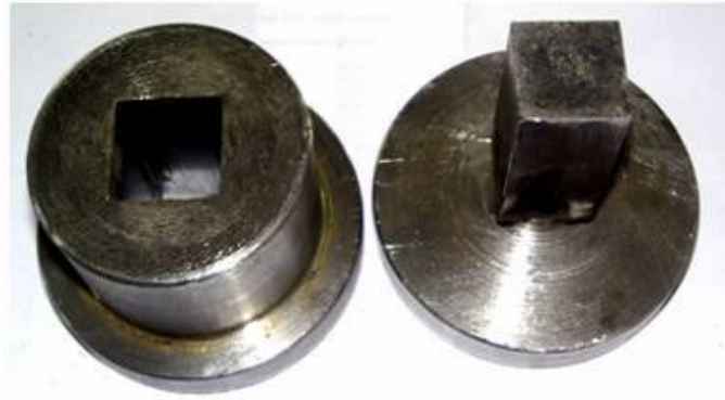
Resim 3.15 Deney Numunelerinin Üretildiği Soğuk Presleme Kalıbı
