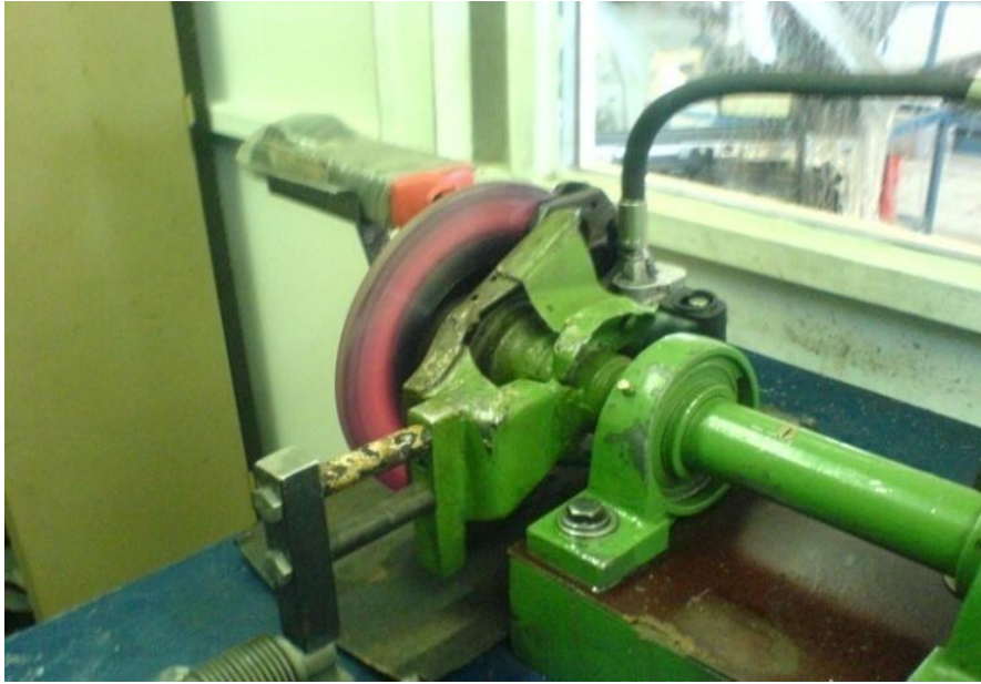
Resim 4.1 Deney Esnasındaki Sürtünmeden Dolayı Oluşan Isının Fren Diskinde Meydana Getirdiği Durum
