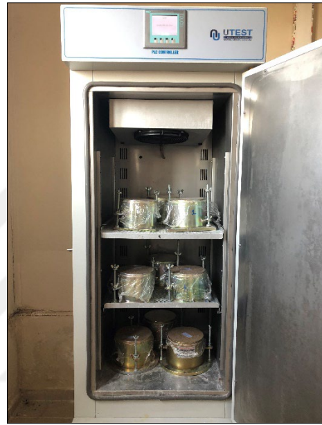
Şekil 5.15. Kapalı sistem donma-çözünme cihazı
