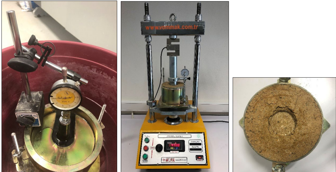
Şekil 5.13. Yaş CBR deney aşamaları
