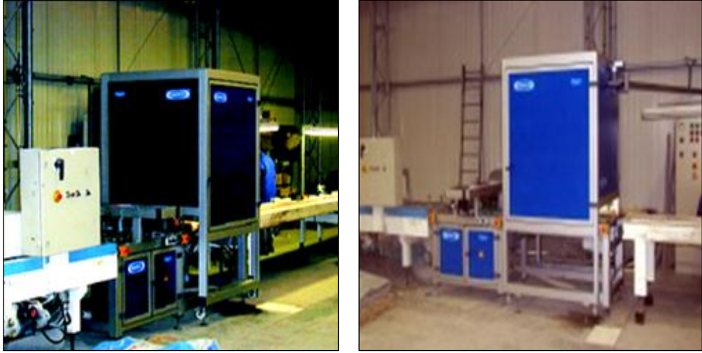
Şekil 4.1 MARCO isimli optik görüntü alma cihazı
