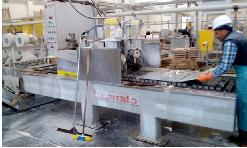
Şekil 6.12 Çalışmada kullanılan boy ebatlama makinesi (Kişisel arşiv, 2018)
