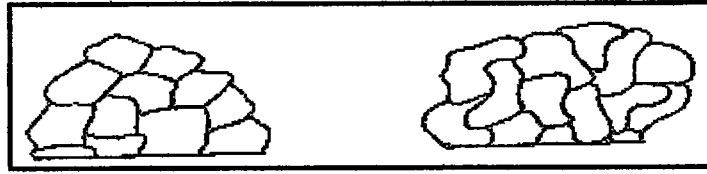
a b Şekil 2.20. Kristal sınırlarının değişimine göre mermerlerdeki sertlik değişimleri. a) yumuşak mermerler, b) Sert mermerler (KUN 2000' den düzenlenerek)
