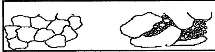
a b Şekil 2.21. Kristal boyutlarının değişimine göre mermerlerdeki sertlik değişimleri a) yumuşak mermerler, b) Sert mermerler (KUN 2000' den düzenlenerek)
