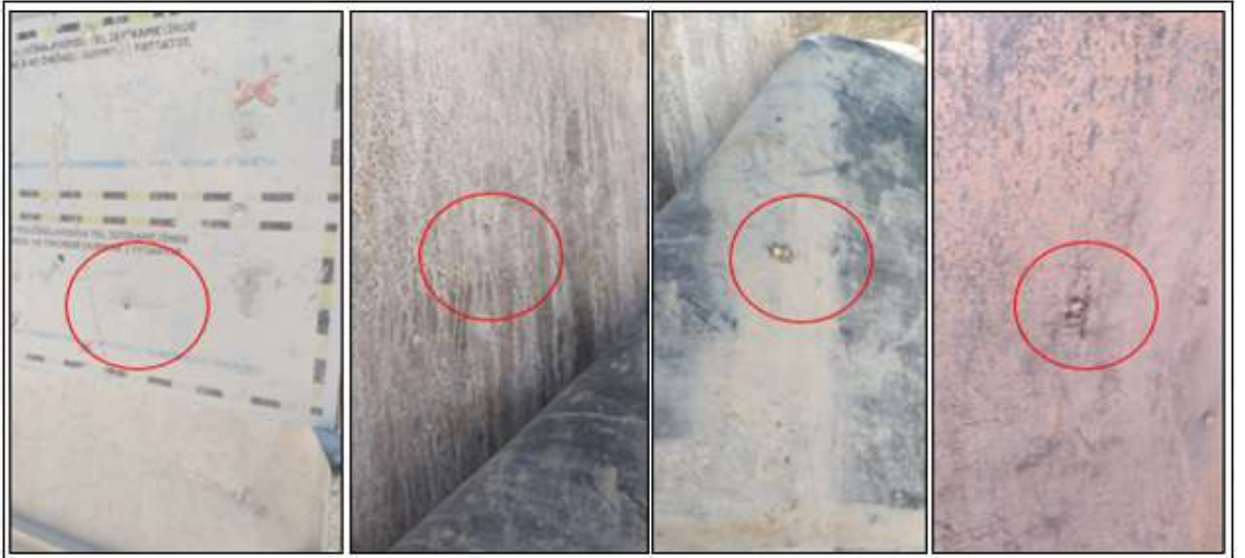
Şekil 27. Elmas tel kopması ile seyyar siperlikte oluşan etkiler
