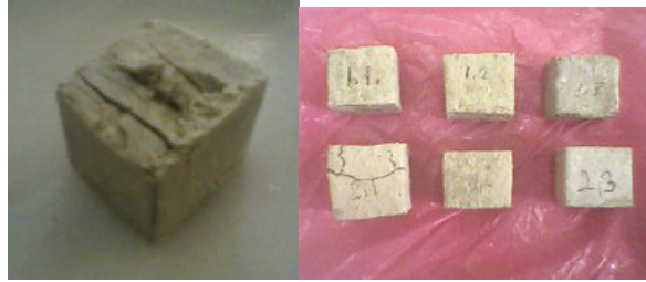
Resim 3.3 Ortoftalik ve izoftalik reçinelerle hazırlanan örnekler. Soldaki resim örneğin kırılma davranışını göstermektedir.
