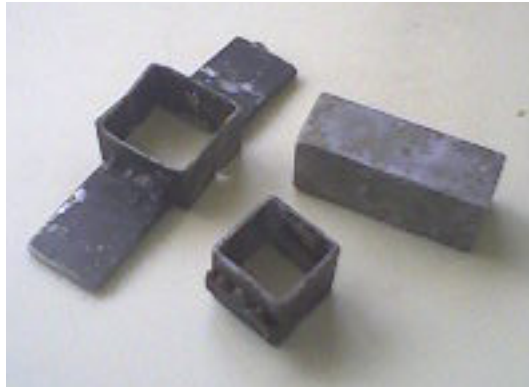
Resim 3.1 Örneklerin hazırlanmasında kullanılan kalıplar.
