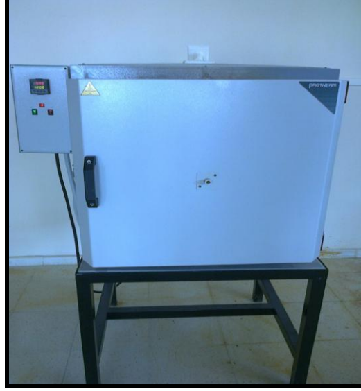
Şekil 3.12. Seramik tabletlerin pişirildiği Protherm marka HLF50 model kül fırını
