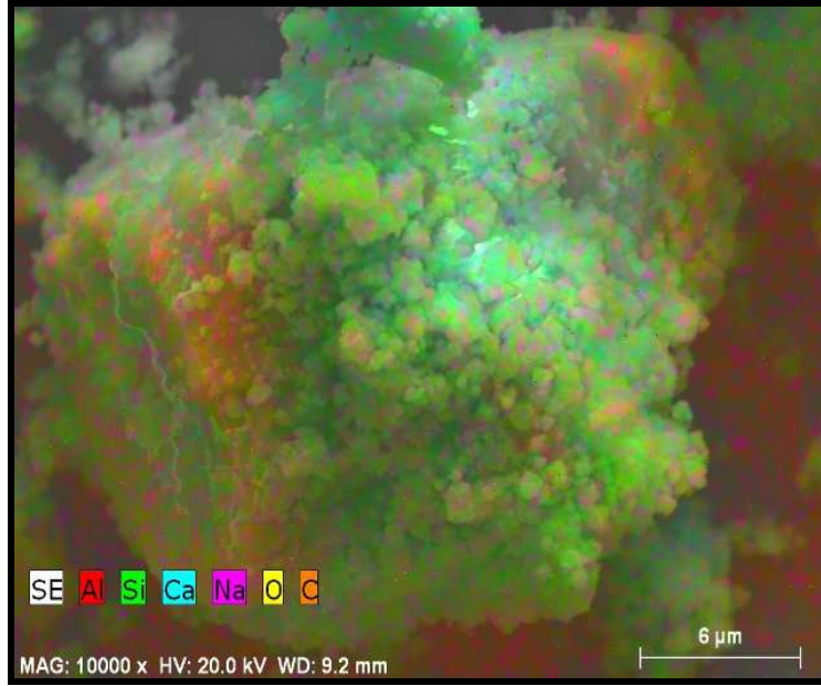
Şekil 4.17. \text{CaO/SiO}_2=1/1,1 olan ve Bilya/Karışım ağırlıkça oranı 20 olan öğütme ortamında 30' öğütülen (019 kodlu numune) örneklerine ait element dağılımını içeren SEM-EDX analiz görüntüleri
