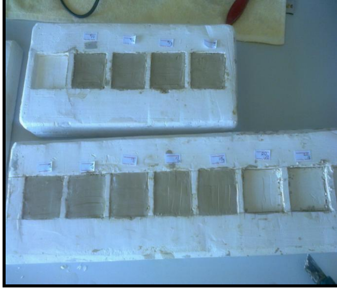
Şekil 3.10. 5×5×5mm boyutlarında hazırlanan alçı kalıplar
