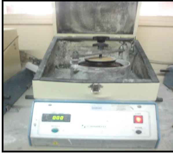
Şekil 3.4. Mekanik aktivasyon sırasında kullanılan Gabbrielli 2B Fast Mill marka 4 adet değirmen
