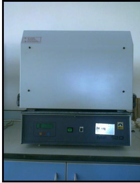
Şekil.3.6.Nüve marka MF120 model kül fırını
