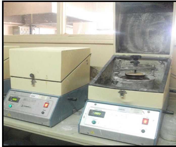
Şekil 2.4. Sır hazırlamada kullanılan Gabbrielli Mill-2B marka bilyalı jet değirmen
