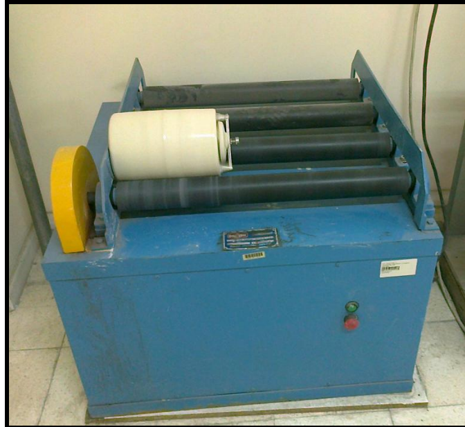
Şekil 3.8. Denver marka Bilyalı Değirmen
