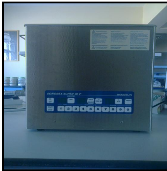
Şekil 3.13. Su emme testlerinin yapıldığı Sonarex Super 10p marka titreşimli su banyosu
