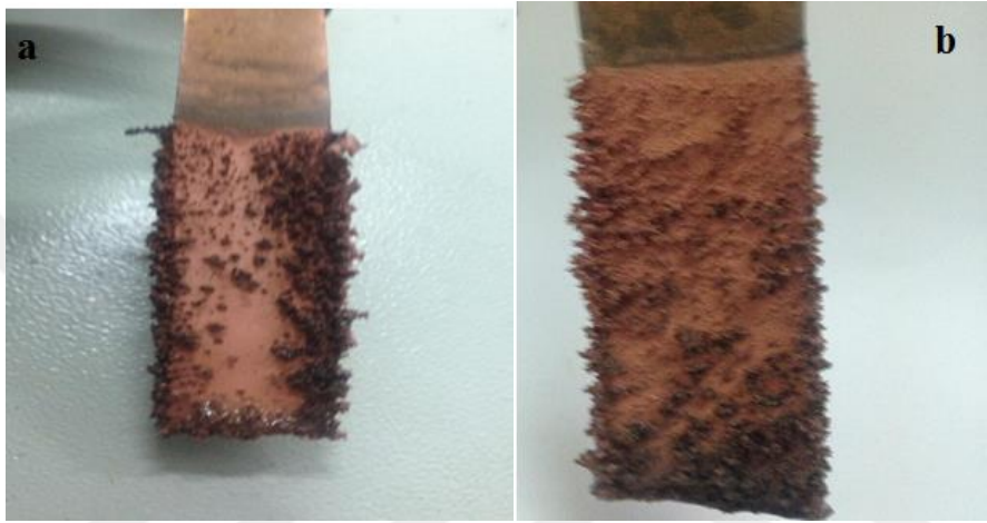
Şekil 3. 18. a)25°C’de ve b)50°C’de katot yüzeyi makro morfolojisi
