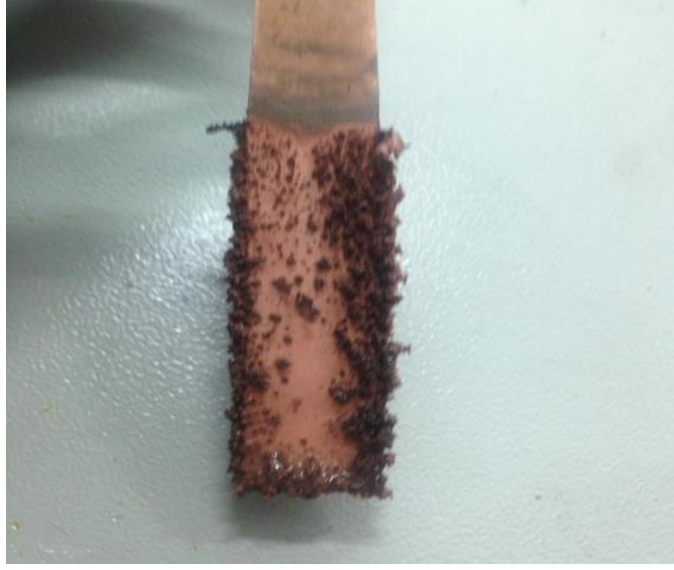
Şekil 3. 4. Deney sonrası katot yüzey görünüm
