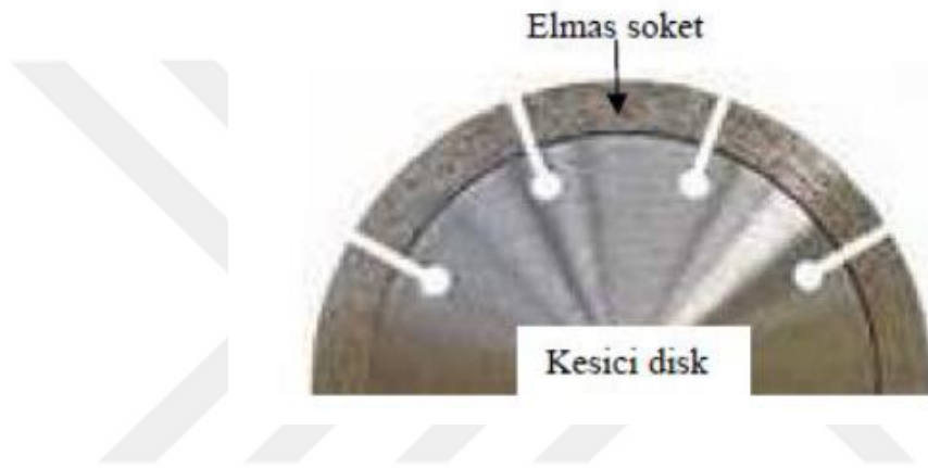
Şekil 1. 4. Kesici döner disk etrafında elmas soketler (Çelik, 2009).
